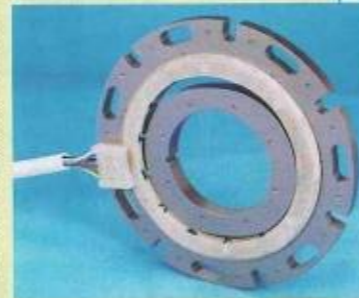
高温に強い レゾルバと呼ばれる角度センサーがハイブリッド車には不可欠
