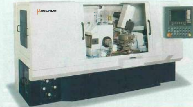
円はまかせる すり並んだ円柱・円筒形の加工品(上)と心なし研削盤
